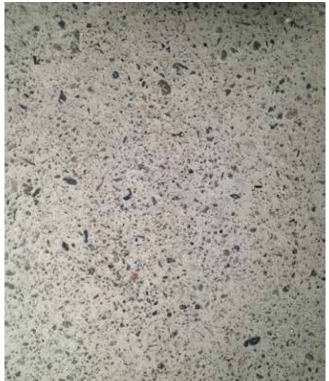
Càsa Cortini: Kalkmörtelüberzug nach eigener Rezeptur. Handgemischt mit Kies aus dem Fluss Orlegna.
